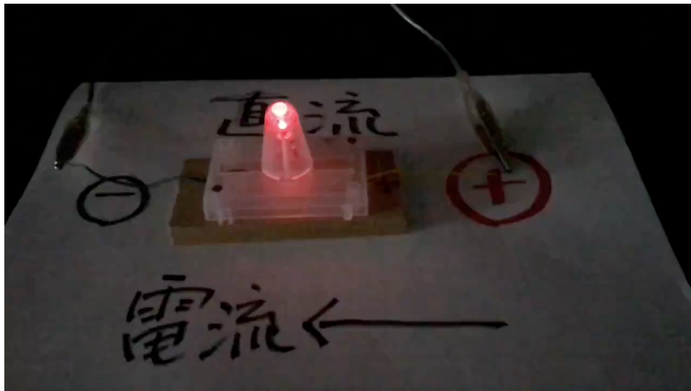
直流電流でLEDを点灯させる
